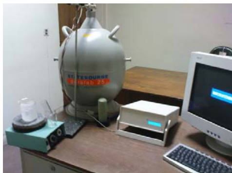
شکل ۱ (الف) - دستگاه مقاومت‌سنج الکتریکی: تجهیزات مورد نیاز برای اندازه‌گیری میزان رسانایی الکتریکی سیم‌ها
